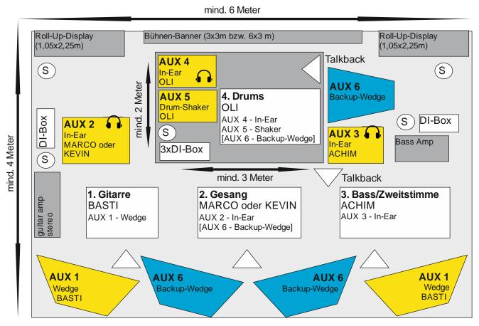
An den Stellen, die durch einen Kreis mit der Beschriftung "S" im Schaubild markiert sind, müssen 3-fach Stromverteiler bereitliegen.
